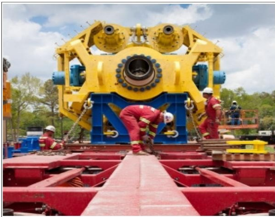
شکل ۷ | موفقیت شرکت شل برای انتقال یک سیستم درپوش به طول ۷ متر، تا عمق ۲۰۰۰ متری
