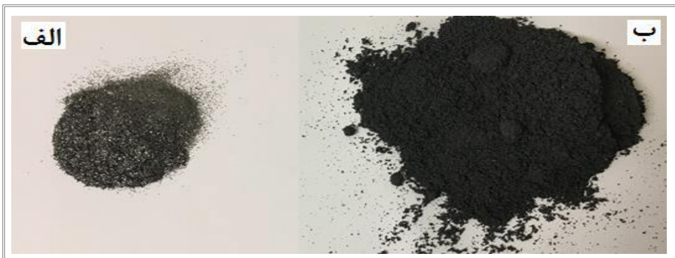
شکل ۱ | الف) پودر گرافیت ساده ب) گرافیت منبسط شده‌ی ورقه‌ای
