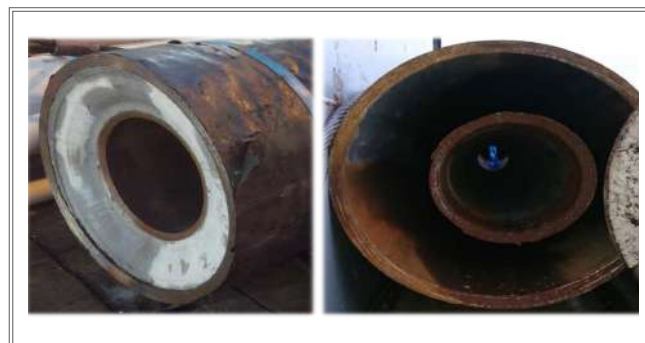
شکل ۱۵ | دالیز بین جداری ۲۰ اینچ و لوله هادی. مقایسه بین به کار بردن MPC و روش معمول. [۳۴]
