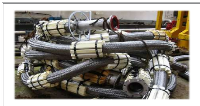
شکل ۵ | شلنگ مکش و قطعات شناور کننده. [۵]
