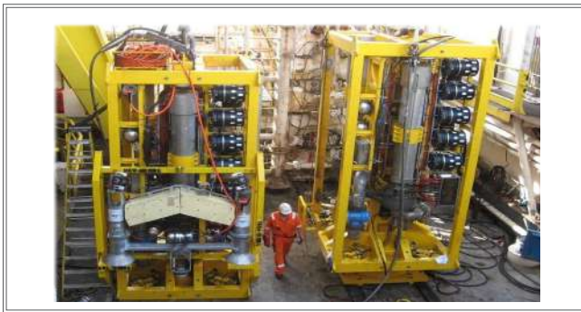
شکل ۴ | ماژول پمپ زیر دریایی بالایی (سمت راست) و پایینی (سمت چپ) [۵]
