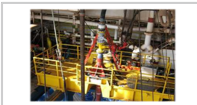
شکل ۶ | سر جریان و مازول آویزان کننده. [۵]
